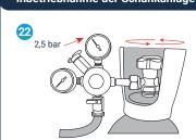
CO<sub>2</sub>-Zufuhr öffnen (Flasche aufdrehen). Mindestens 2,5 bar.
